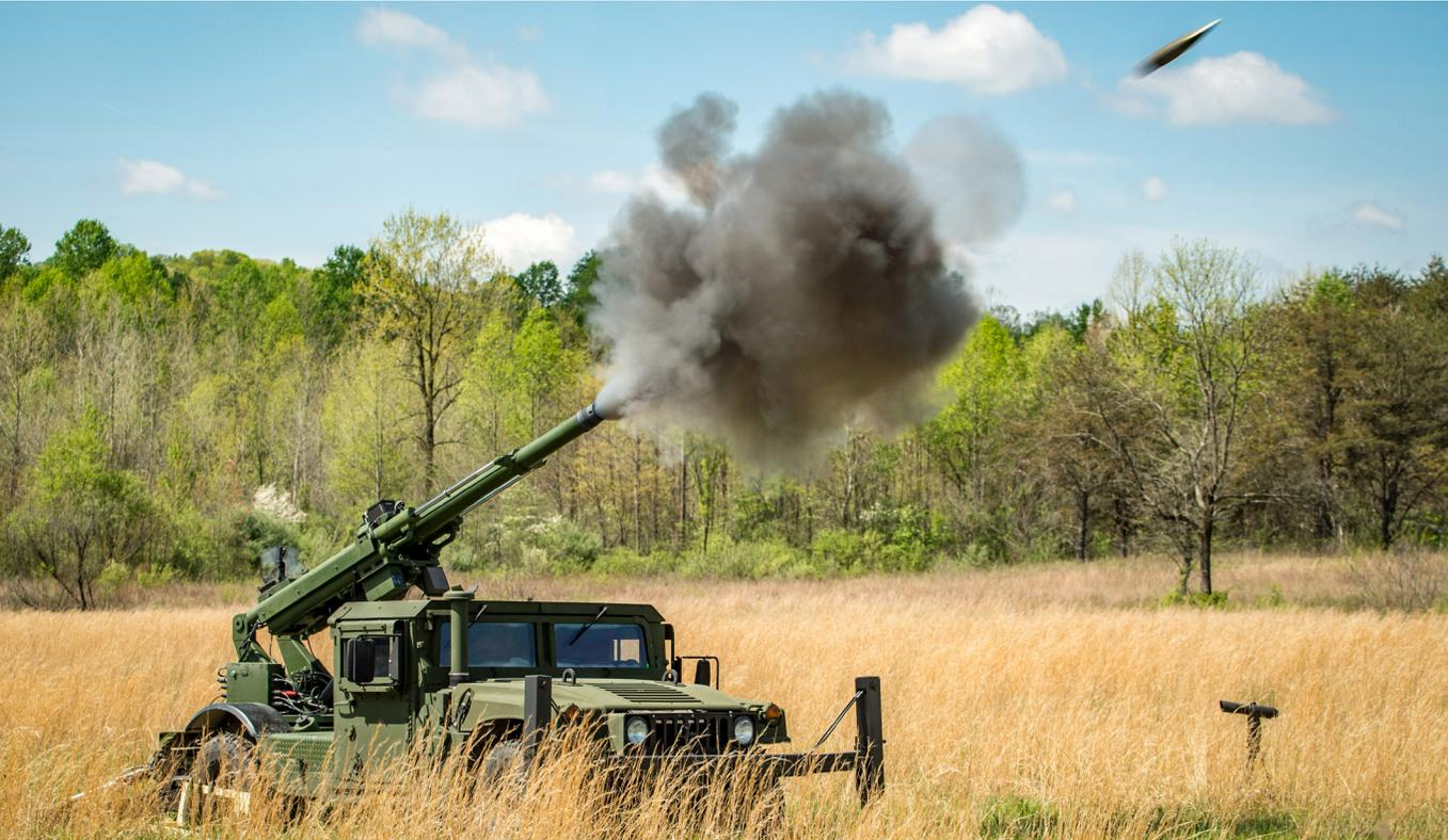
**SISTEMA** — El sistema de armas móviles de 105mm presenta el cañón tipo howitzer autopropulsado de mayor maniobrabilidad y de menor peso actualmente en todo el mundo. El sistema consiste en un cañón de 105mm estándar M20 de la U.S. Army, montado sobre una M1152A1w/B2 HMMWV. El arma incluye la aplicación de un sistema de control de disparo digital y comunicación integrada, lo que elimina la necesidad de puntos de activación supervisados, goniómetros brújulas y líneas de servicio.
